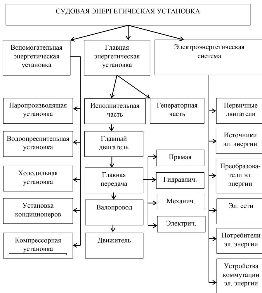
Рис. 1. Составные элементы судовой энергетической установки
