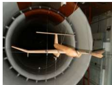
Рис. 2. Модель крыла в составе экраноплана в аэродинамической трубе
