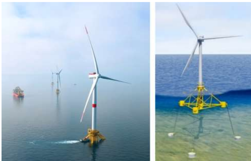
Рис. 6. Платформа TLP Provence Grand Large (а – фото, б – 3D-визуализация) [9, 10]
