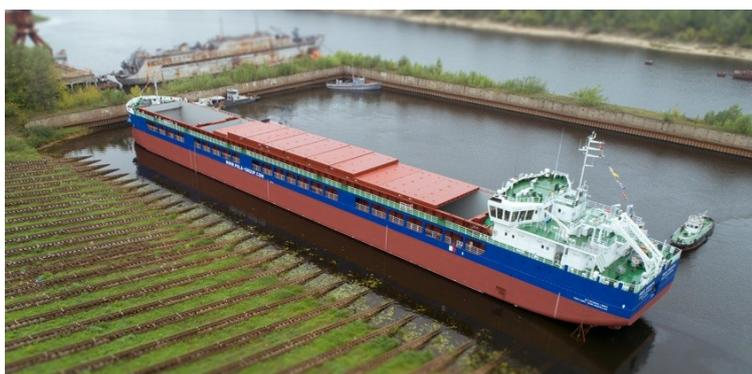
Рис.2. Судно река-море проекта RSD59
