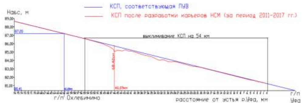
Рис.3. Кривые свободной поверхности воды до и после разработки карьеров НСМ в период с 2011г. по 2017г. // Curves of the free water surface before and after the development of quarries of building materials in the period from 2011 to 2017
