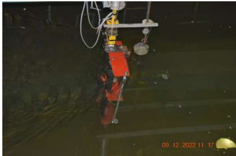
Рис.3. Протяжка ГДЯ в бассейне на рабочем ходу: видно рабочее расположение крыльев с опорой на основную плоскость
