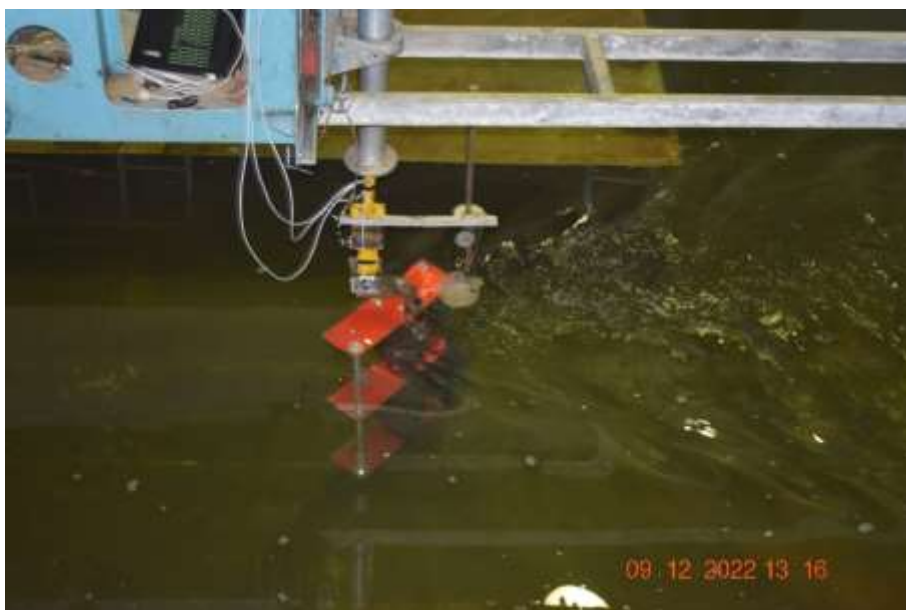
Рис.4. Протяжка ГДЯ в бассейне на холостом ходу: крылья развёрнуты от основной плоскости
