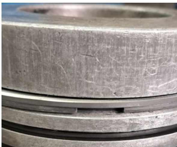
Рис. 4. Расположение компрессионных колец в расточенной поршневой канавке
