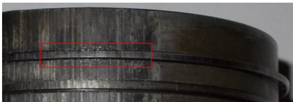
Рис. 1. Разрушение кромок верхней поршневой канавки
