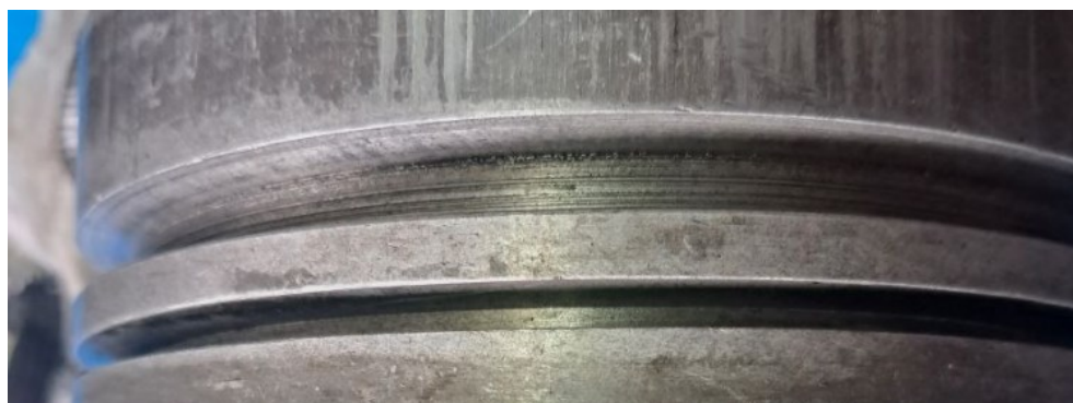
Рис. 3. Поршень с расточенной первой поршневой канавкой под два компрессионных кольца
