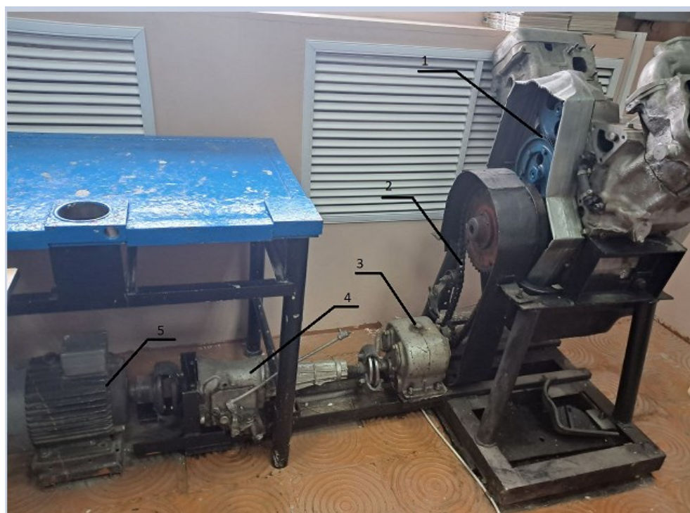
Рис. 2. Стенд для испытаний нового кольцевого уплотнения
