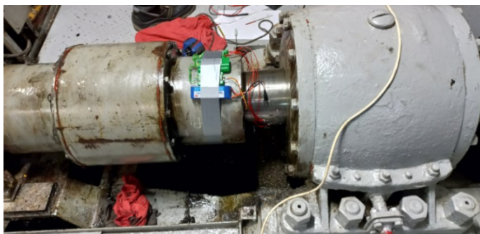
Рис. 7. Место наклейки датчиков вблизи опорного подшипника
