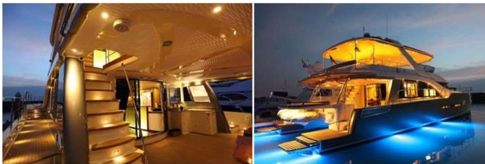
Рис. 9. Система освещения на яхте-катамаране пр. Н65. Показано освещение палуб, ступенек, потопчин и подводные светильники
