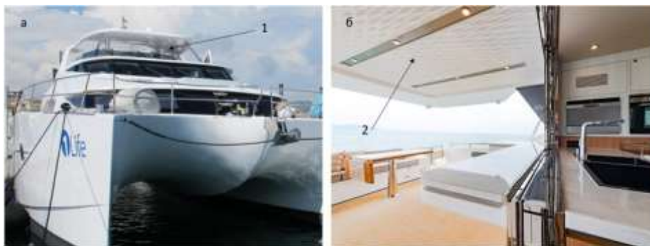
Рис. 10. Внешний вид подволока; а - на катамаране Sunreef; б - на катамаране пр.CC48. Показаны дефекты глянцевой поверхности (1) и текстурированное покрытие (2)
