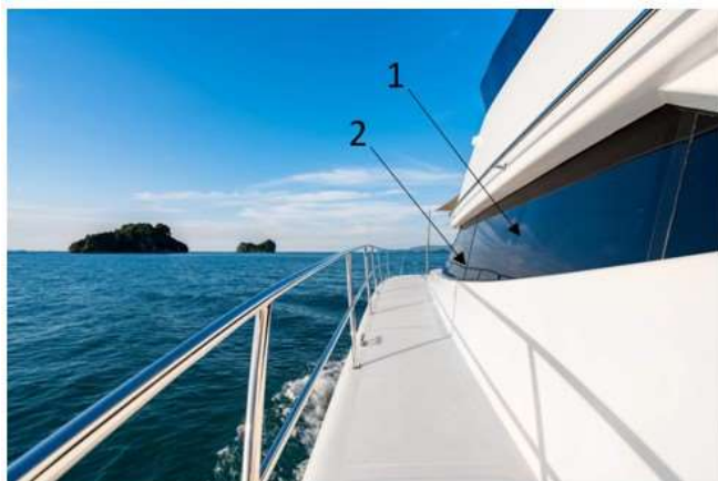
Рис. 11. Качественное исполнение остекления на катамаране пр.АВ45. Отсутствует волнистость (1), в стыке стекол отражение релингов сходится в одну точку (2)
