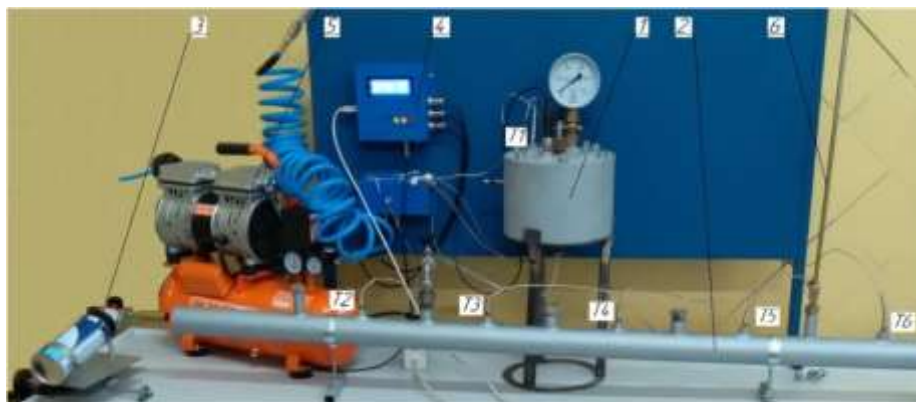
Рис. 1. Стенд для термического обезвреживания нефтесодержащих вод 1 – напорный бак, 2 – газоход, 3 – источник горячих газов, 4 – блок регистрации измерений, 5 – компрессор, 6 – зонд газоанализатора
