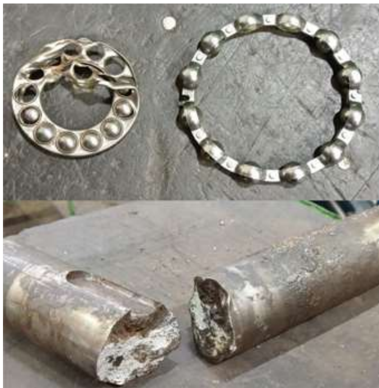
Рис. 2. Общий вид выхода из строя подшипника качения и излома вала
