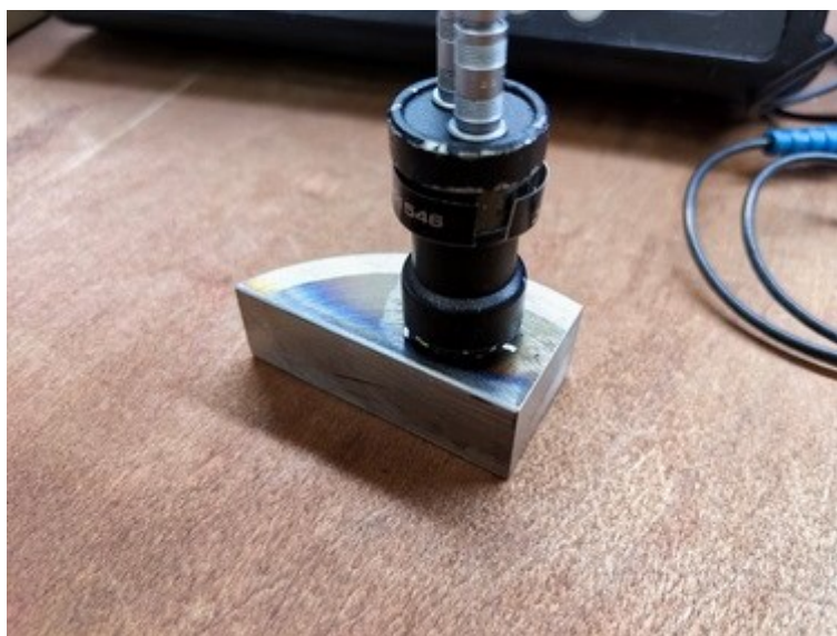
Рис. 3. Контроль скорости упругой волны
