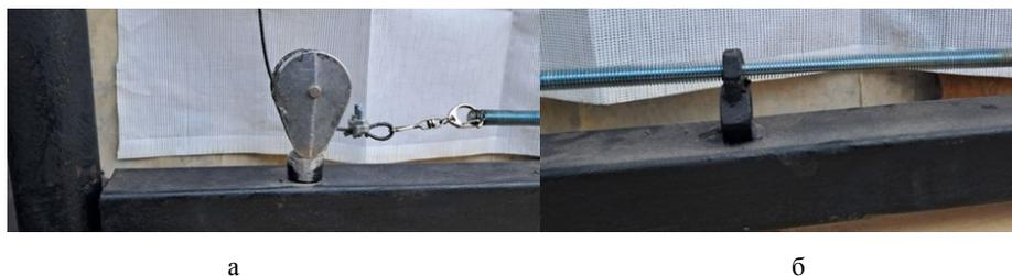
Рис. 14. Детали стенда: а – детали соединения троса с натяжным винтом; б – упор, относительно которого перемещается натяжной винт
