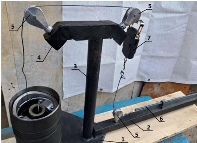
Рис. 10. Общий вид стенда для замера величины силы трения: 1 – основание; 2 – опора; 3 – стойка; 4 – перекладина; 5 – ролик; 6 – натяжной винт; 7 – динамометр; 8 – центрирующие и фиксирующие болты; 9 – электродвигатель на подвижной опоре
