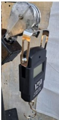
Рис. 13. Установка динамометра
