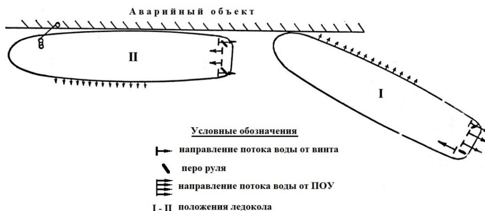
Рис. 1. Схема швартовки ледокола к аварийному объекту
