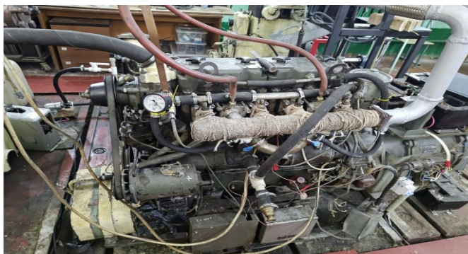
Рис. 1. Модернизированная дизель-генераторная установка для работы на традиционных и смесевых видах топлив
