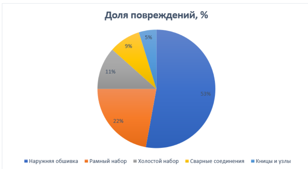
Рис. 2. Распределение критических повреждений по элементам корпусов судов
