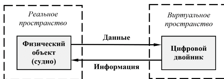
Рис. 2. Простейшая визуализация концепции цифрового двойника (основные части цифрового двойника)
