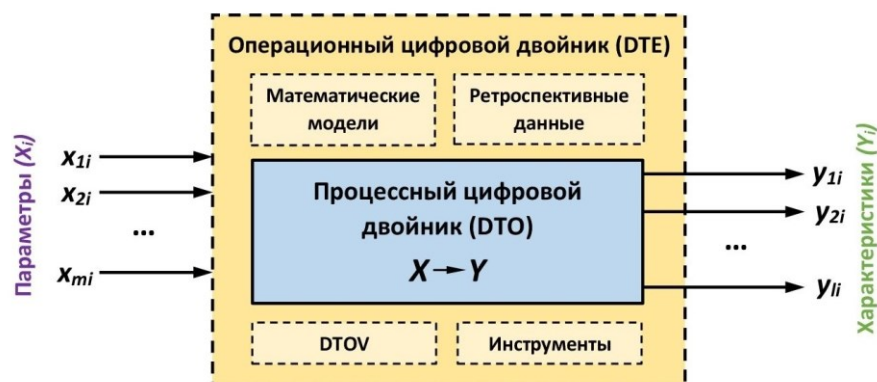
Рис. 4. Процессный эксплуатационный цифровой двойник судна
