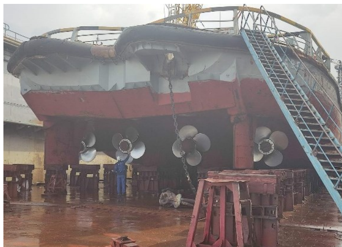
Рис. 1. Ремонт судна с четырьмя валовыми линиями
