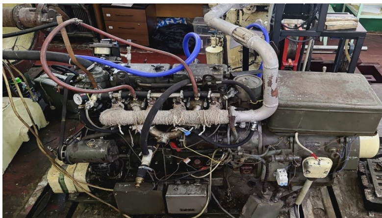
Рис. 1. Модернизированная дизель-генераторная установка для работы на традиционных и смесевых видах топлив
