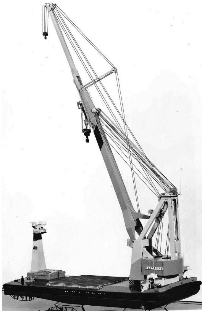
Рис. 3. Модель плавкрана «Богатырь» с дополнительной (вантовой) стрелой грузоподъемностью 100 тонн
