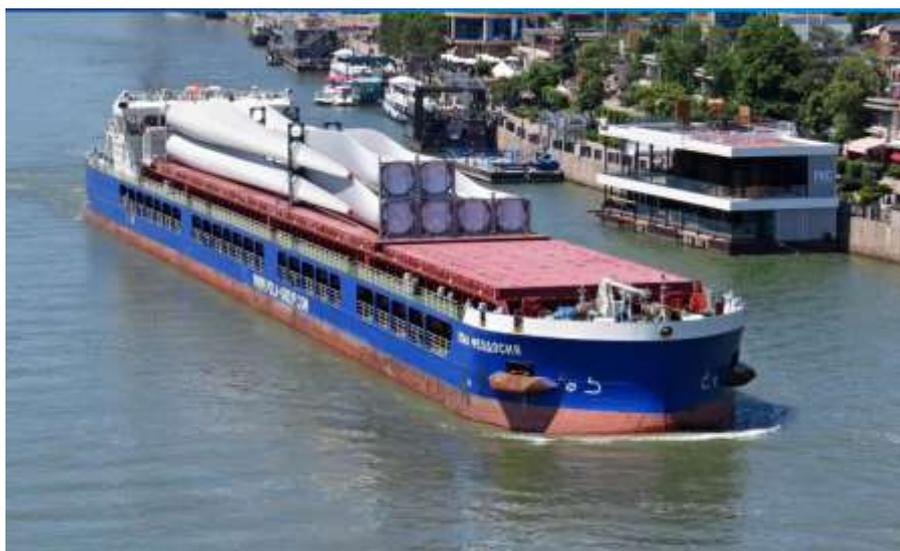
Рис. 10 Перевозка негабаритного груза судном проекта RSD59. Источник: [3]
