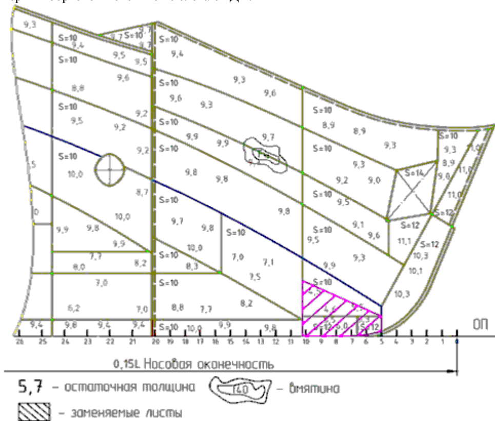
Рис. 3. Локализация износов наружной обшивки в носовой части сухогрузного теплохода с ледовым усилением (фрагмент)
