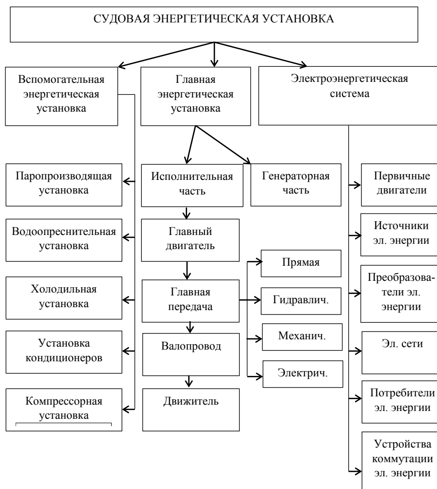
Рис. 1. Составные элементы судовой энергетической установки
