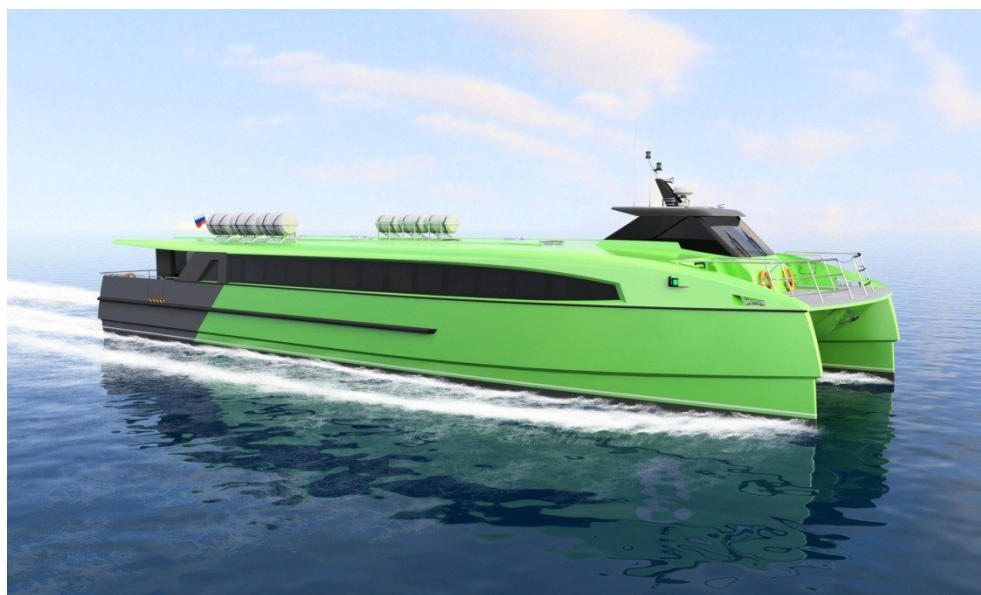
Рис. 3. Перспективный катамаран из КМ длиной 30м на 250 пассажиров с электродвижением – проект AMD
