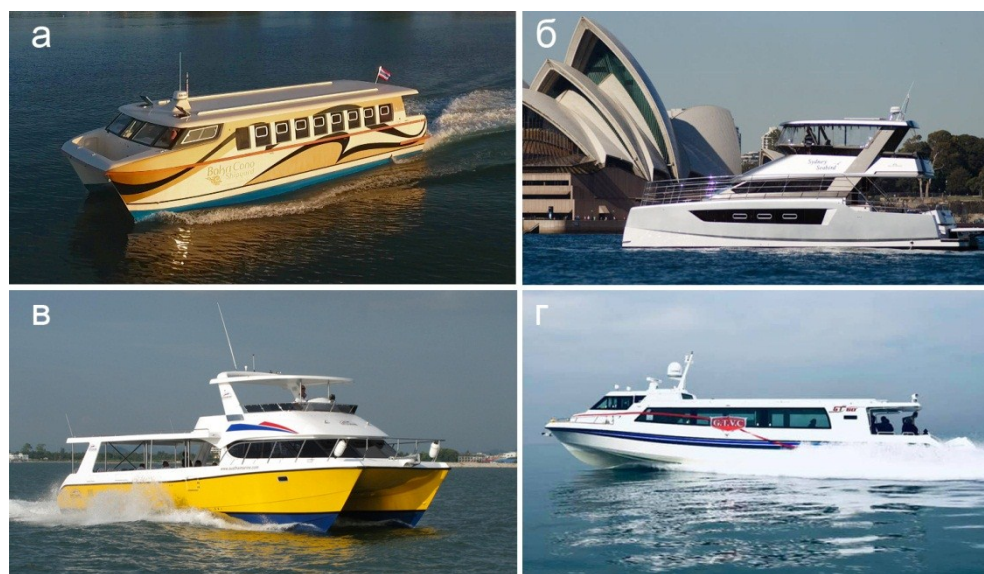
Рис. 2. Пассажирские суда из КМ (проекты AMD) а) катамаран пр. ASV1500 на 54 пассажира; б) катамаран пр. Н48 на 36 пассажиров; в) катамаран пр. АТ1500 на 115 пассажиров; г) однокорпусное судно пр. SB60V на 40 пассажиров
