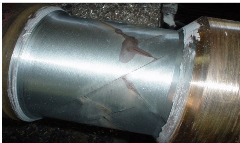
Рис. 7. Трещины гребного вала под вскрытой изоляцией
