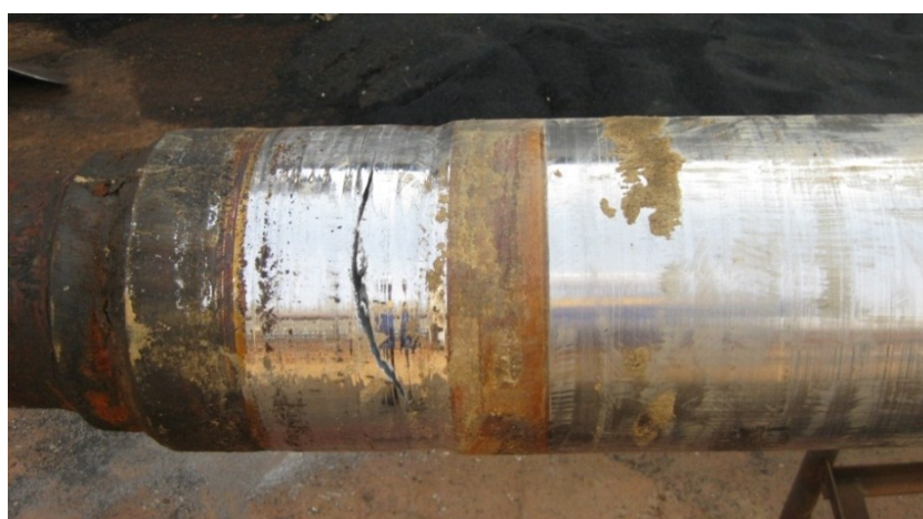
Рис. 9. Глубокая трещина – разрушение гребного вала
