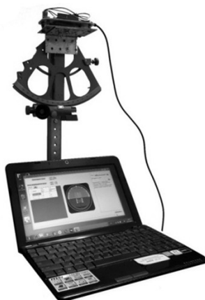
Рис. 6. Общий вид поверочного стенда для автоматического регистратора параметров качки судна
