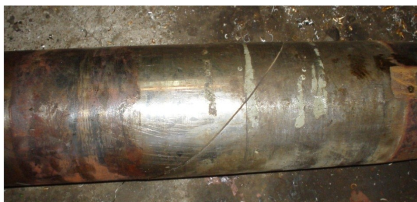
Рис. 8. Трещина вала судна пр.1577 типа «Волгонефть»
