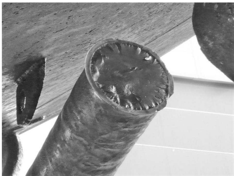
Рис. 2. Фотография кормовой части гребного вала в районе разрушения (из материалов судебного дела)
