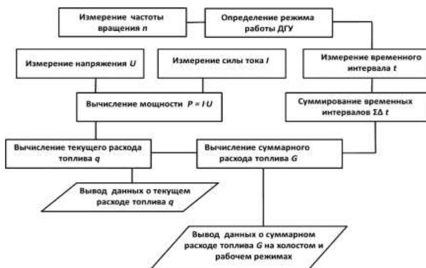
Рис. 1. Блок-схема алгоритма оценки энергетической эффективности дизель-генераторной установки
