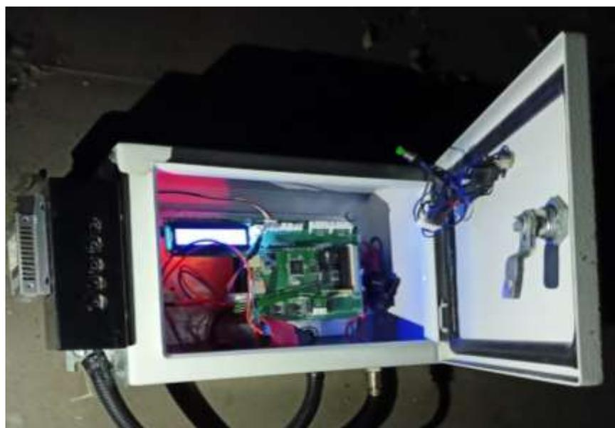
Рис.2. Монтажный блок аналитической системы контроля энергетической эффективности
