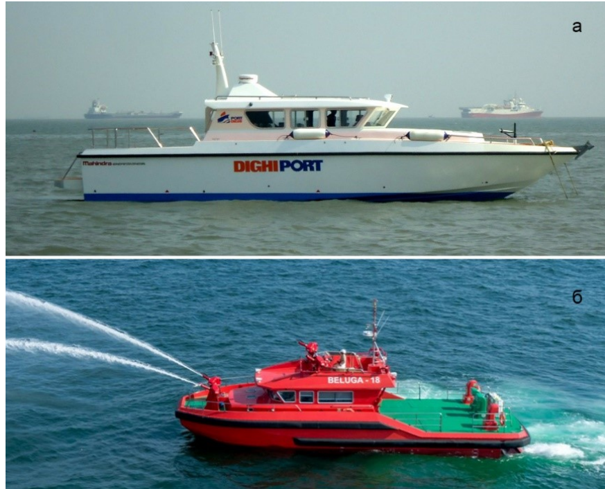
Рис. 1. Суда из КМ (проекты AMD): а) служебный катер пр.МОВ14 (Индия), класс GL; б) спасательный катамаран с противопожарным оборудованием пр.СМFF18 (ОАЭ), класс LR.
