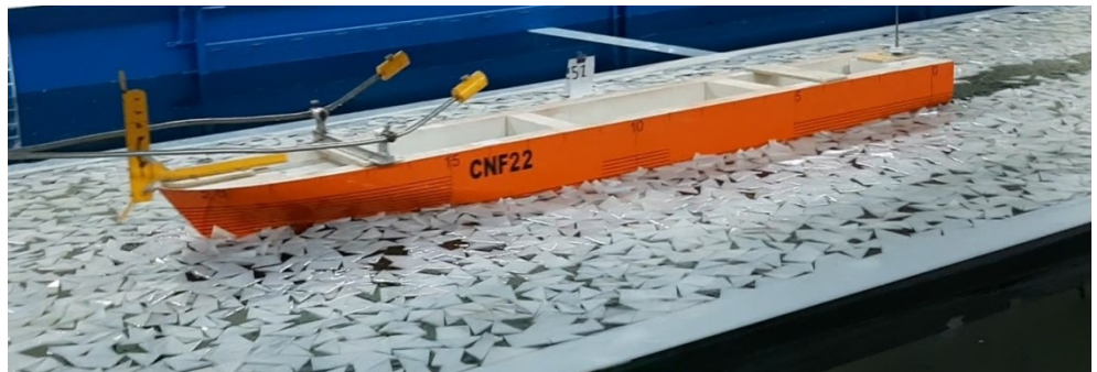
Рис. 8. Фрагменты движения модели носом во льду сплоченностью 8 баллов и скоростью ~ 12 уз.
