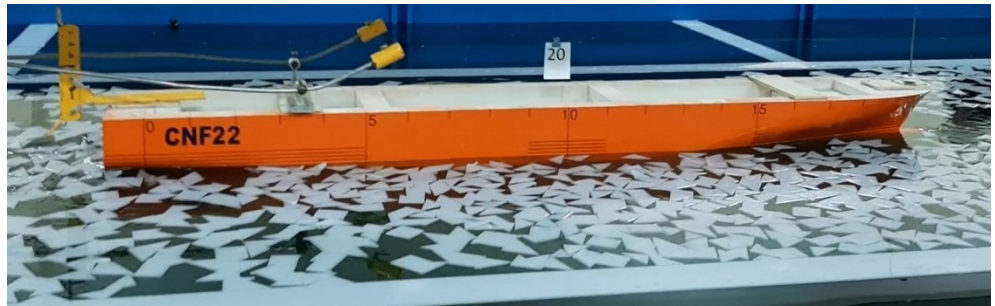
Рис. 6. Фрагменты испытаний при движении модели кормой во льду сплоченностью 4 балла и скоростью ~ 6 уз.
