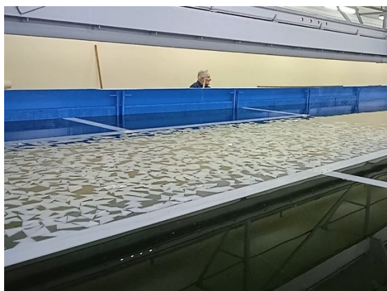
Рис. 4. Поле битого льда сплоченностью 4 балла в опытовом бассейне
