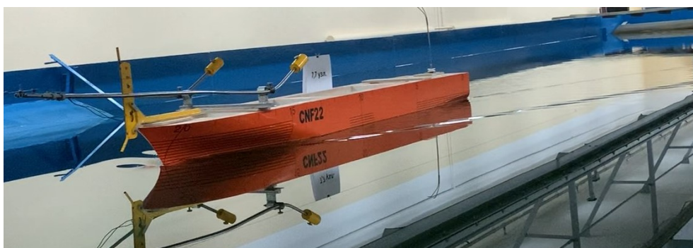
Рис. 5. Фрагмент испытаний модели при движении носом на скорости для натуре ~ 8 узлов
