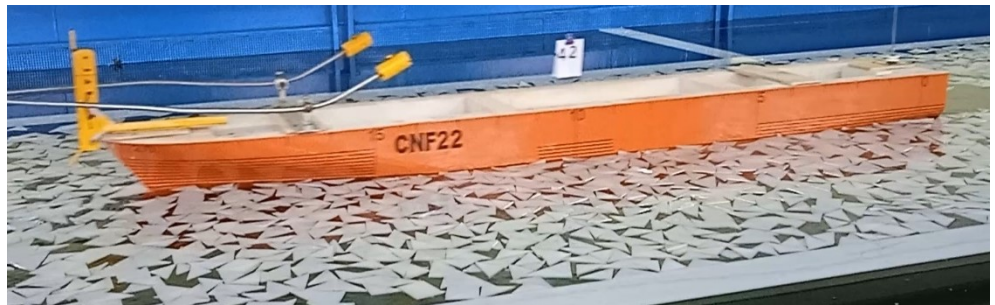
Рис. 7. Фрагменты движения модели носом во льду сплоченностью 6 баллов и скоростью ~ 6 уз.
