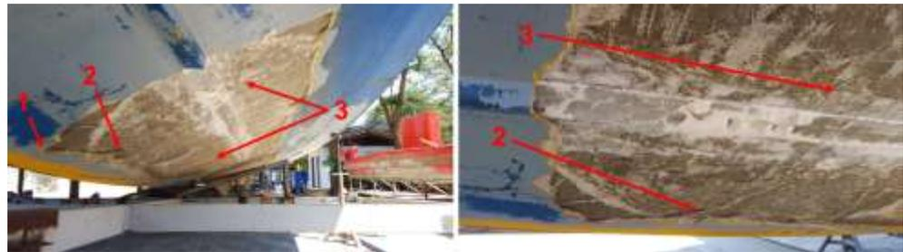
Рис. 3. Повреждения наружной оболочки пассажирского судна длиной 14,3м; 1 – место удара о скалу, видны идущие вдоль киля царапины; 2 – сквозная трещина в обшивке; 3 – межслойная деламинация обшивки
