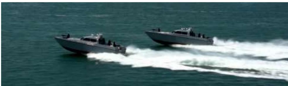
Рис. 1. Катера-перехватчики пр.SM16 из КМ трехслойной конструкции
