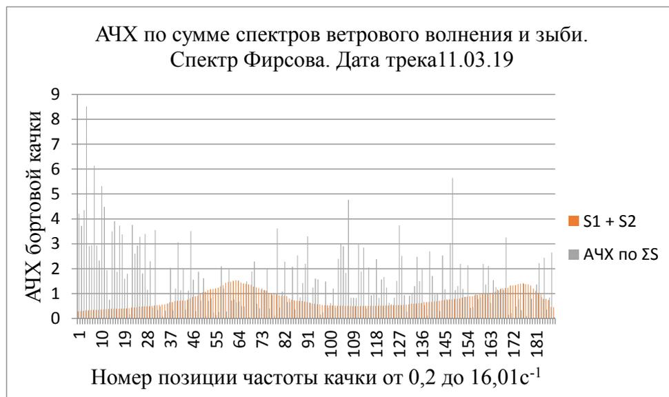
Рис. 3. Амплитудно-частотная характеристика, полученная по суммарному спектру ветрового волнения и зыби
