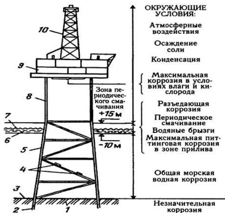
Рис. 1. Районы коррозии и методы защиты от нее морских стационарных платформ:
