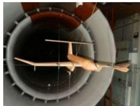
Рис. 2. Модель крыла в составе экраноплана в аэродинамической трубе
