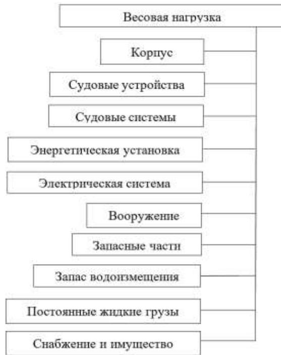
Рис. 16. Структурная схема формирования весовой нагрузки судов обеспечения подводно-технических работ
