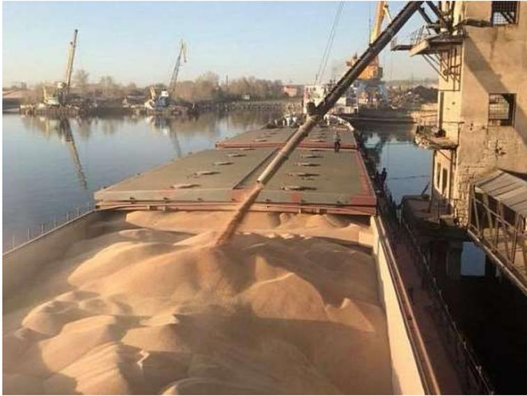
Рис. 6. Погрузка зерна в речное судно
