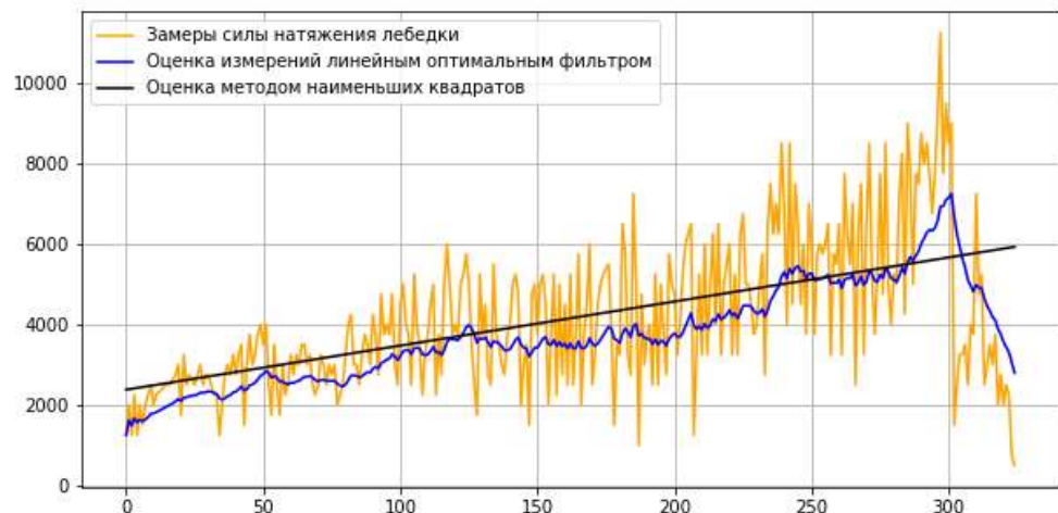
Рис. 3. Обработка замеров с датчиков натяжения троса
