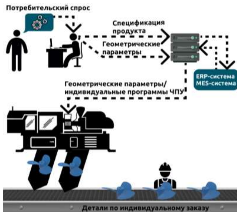
Рис. 4. Поток геометрической информации о продукте от клиента к станку
