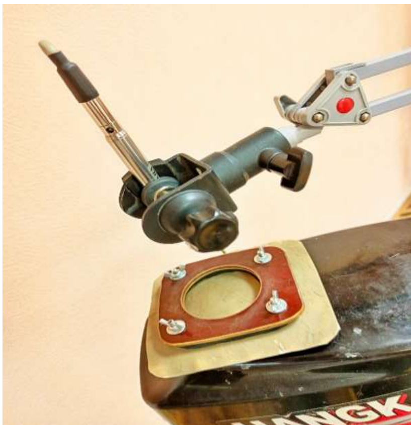
Рис. 3. Вид расположения микрофона на пантографе над отверстием акустического мостика с испытуемым образцом.
