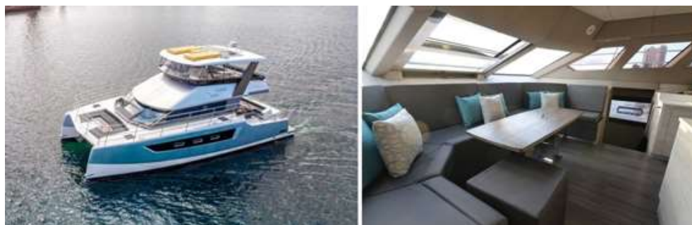
Рис. 4. Катамаран Sydney Seabird пр. Н48 по NSCV категории D на 36 пассажиров. По ускорениям формально соответствует уровню 2, но имеет компоновку салона, кормовой палубы и флайбриджа с диванами, что улучшает потребительские качества судна для увеселительных прогулок
