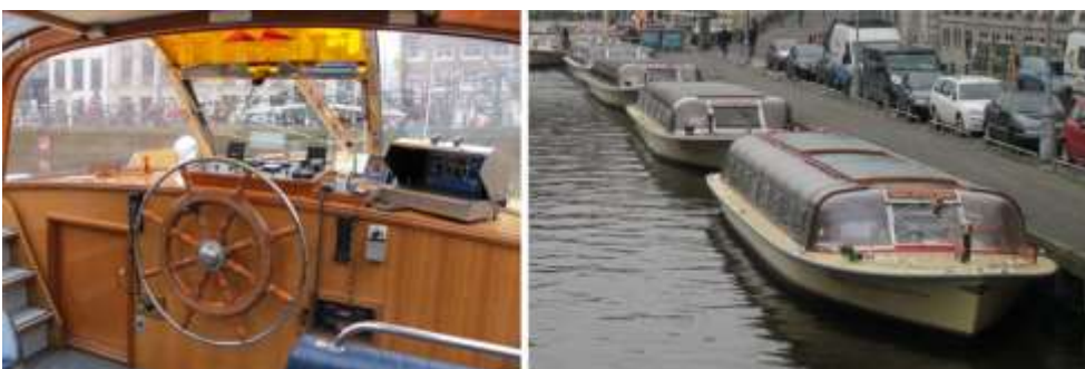
Рис.8. Пост управления на пассажирском экскурсионном судне в Амстердаме (Нидерланды). Для прохода под мостами судно имеет низкий силуэт. Характерна установка карт-плоттера в стальном ящике для предотвращения краж.
