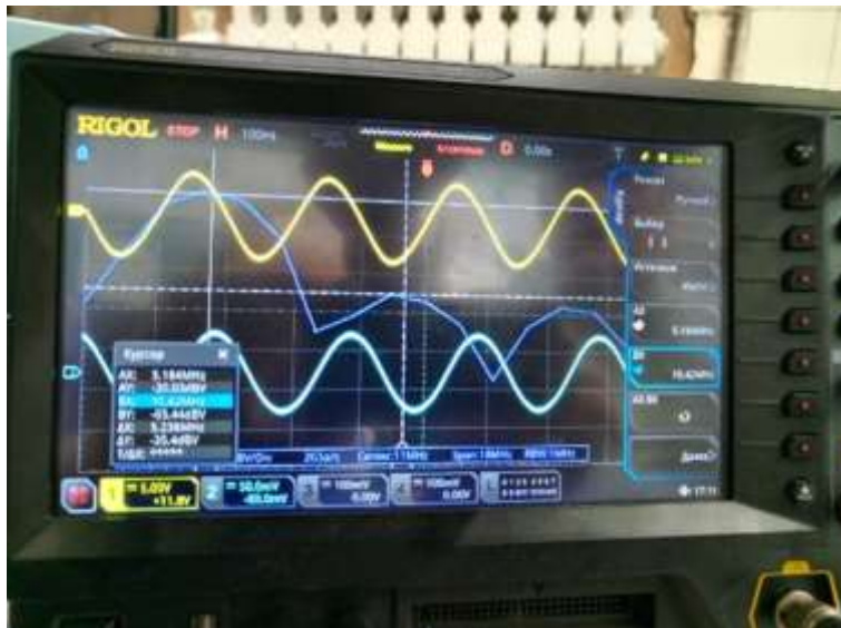
Рис.6. Сигналы на излучающем и приемном ПЭП и спектральный состав зондирующей волны. Образец деформирован на 10 %
