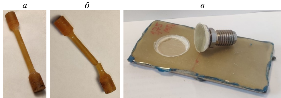
Рис.2. Вид образца из эпоксидного компаунда К-153 до (а) и после (б) испытаний на растяжение, а также оторванный грибок от эпоксидного покрытия в опытах на адгезию (в)
