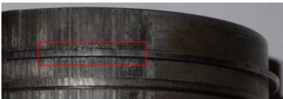
Рис. 1. Разрушение кромок верхней поршневой канавки
