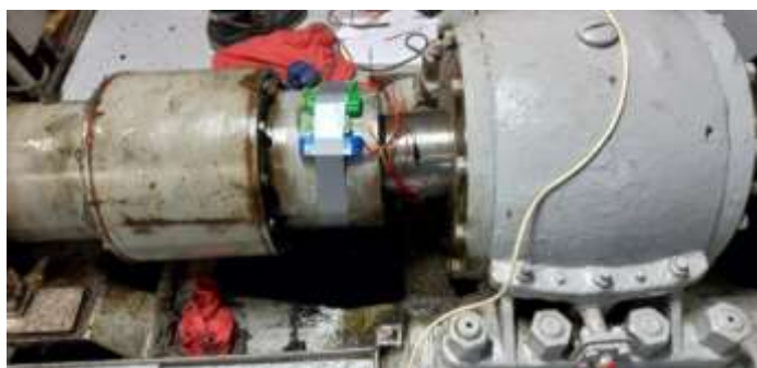
Рис. 7. Место наклейки датчиков вблизи опорного подшипника
