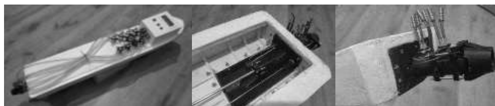
Рис. 3. Внешний вид модели изготовленного пропульсивного комплекса с датчиками давления
