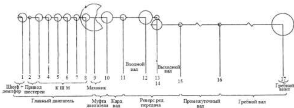
Рис. 2. Расчетная схема ККС валопровода судовой пропульсивной установки судна на подводных крыльях «Комета-120М» проекта 23160
