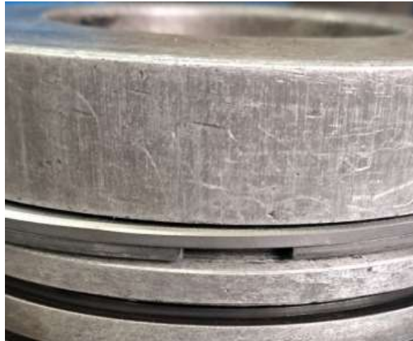
Рис. 4. Расположение компрессионных колец в расточенной поршневой канавке
