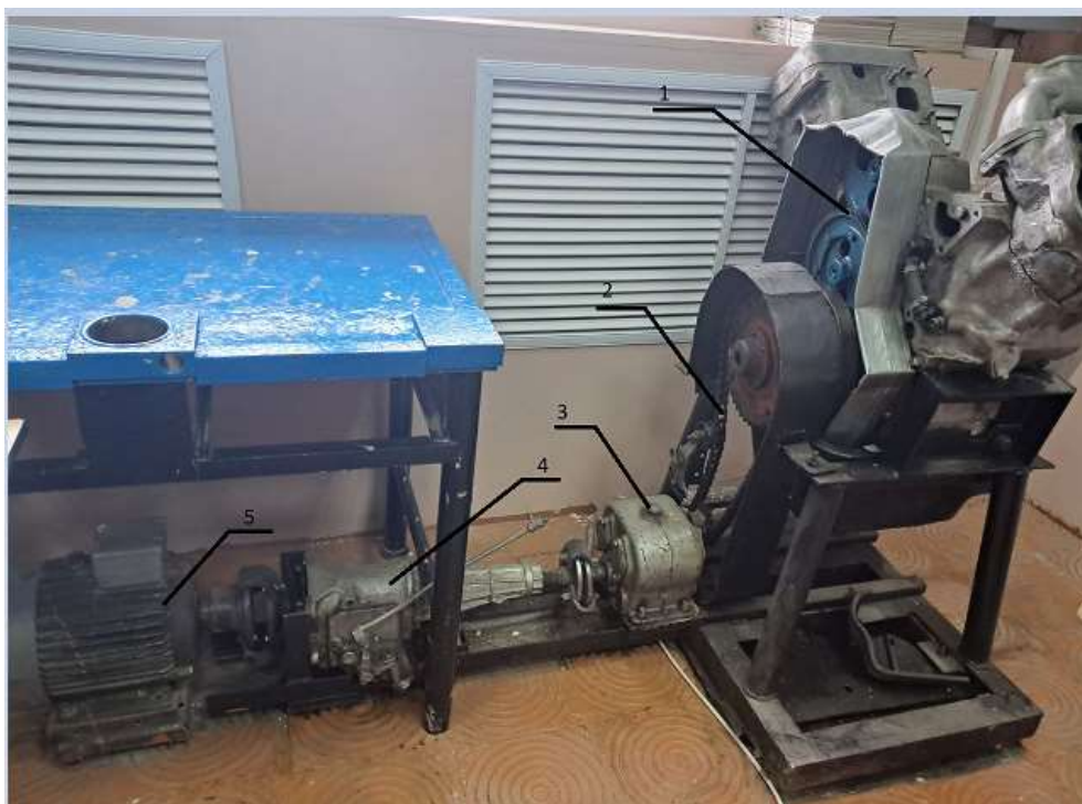
Рис. 2. Стенд для испытаний нового кольцевого уплотнения
