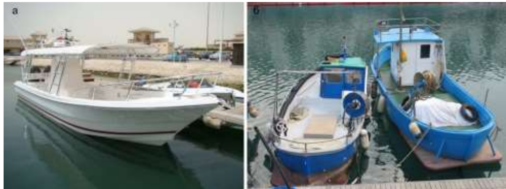
Рис. 6. Малые суда местных типов; а) ranga - плоскодонная лодка характерная для стран Карибского бассейна, стран Африки и Азии, изначально разработана в начале 1970-х компанией Yamaha в рамках проекта Всемирного банка для развивающихся стран; б) gozzo – традиционное рыбацкое судно побережья Италии, изначально парусное; в настоящее время оснащается кормовой надделкой для улучшения ходовых качеств под мотором.
