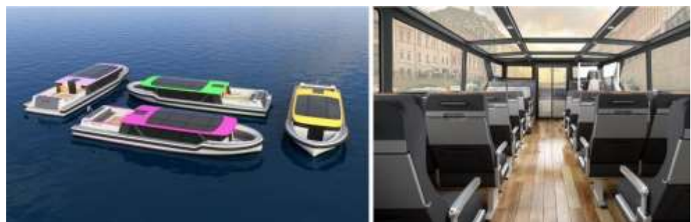
Рис. 9. Судно пр. SP15 с прямым носовым остеклением надстройки; в носовой части салона расположена дверь, поэтому остекление заменять на наклонное по [13] невозможно без существенного ущерба для функциональности и внешнего вида.
