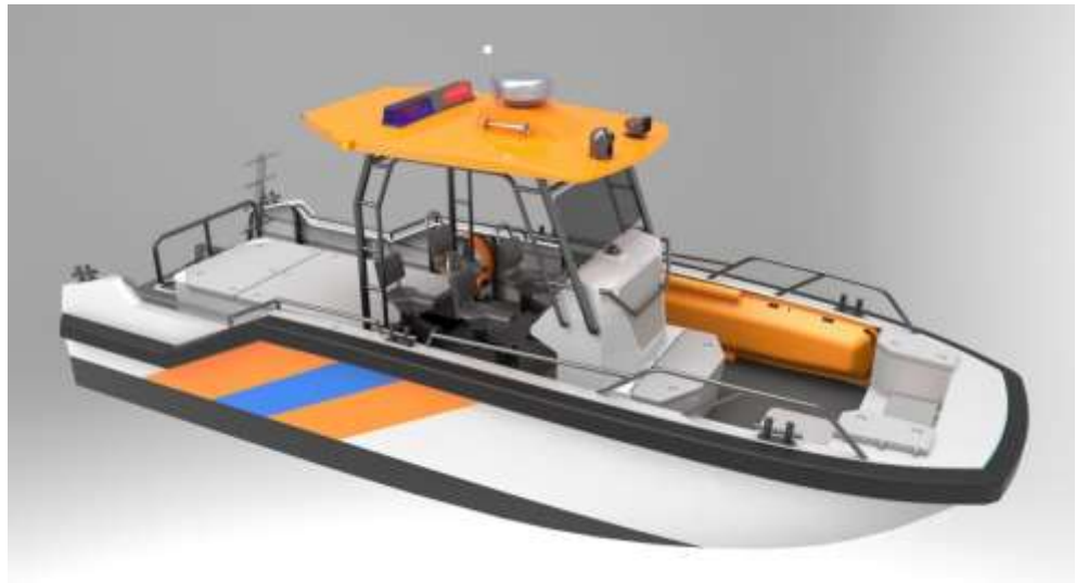
Рис. 11. Служебный катер пр.RPV850, предназначен для патрулирования и спасательных работ; помимо привлекательного внешнего вида, дизайн катера имеет необходимые функциональные черты: проход вдоль бортов, краец из пены вдоль борта, место для пострадавшего и носилок и т.д.
