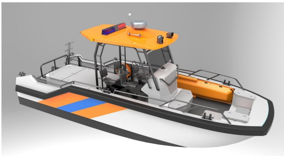
Рис. 11. Служебный катер пр.RPV850, предназначен для патрулирования и спасательных работ; помимо привлекательного внешнего вида, дизайн катера имеет необходимые функциональные черты: проход вдоль бортов, кранец из пены вдоль борта, место для пострадавшего и носилок и т.д.
