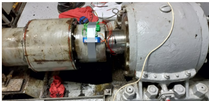
Рис. 7. Место наклейки датчиков вблизи опорного подшипника
