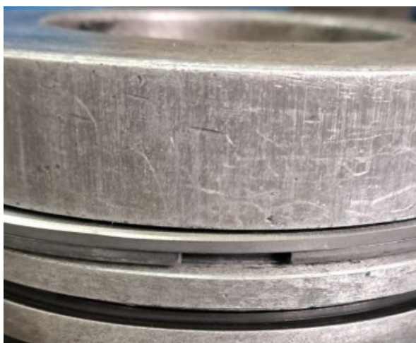
Рис. 4. Расположение компрессионных колец в расточенной поршневой канавке
