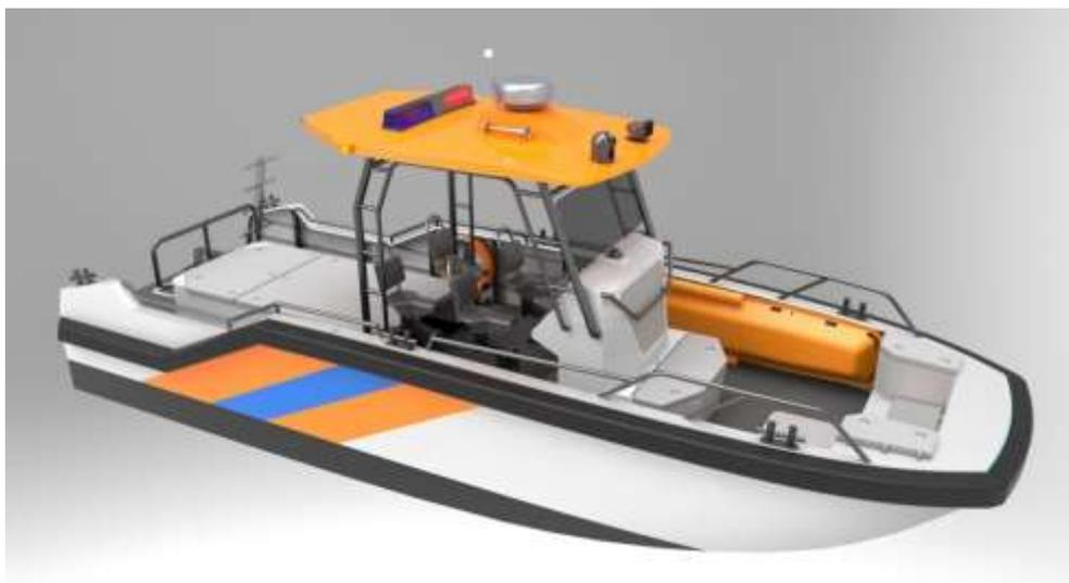
Рис. 11. Служебный катер пр.РРV850, предназначен для патрулирования и спасательных работ; помимо привлекательного внешнего вида, дизайн катера имеет необходимые функциональные черты: проход вдоль бортов, краец из пены вдоль борта, место для пострадавшего и носилок и т.д.
