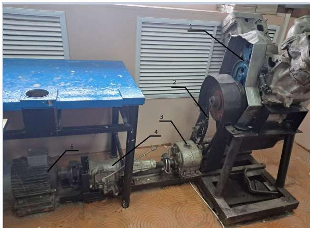
Рис. 2. Стенд для испытаний нового кольцевого уплотнения
