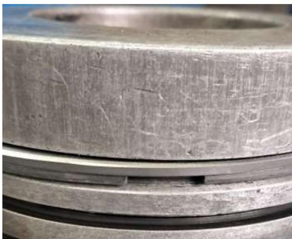
Рис. 4. Расположение компрессионных колец в расточенной поршневой канавке
