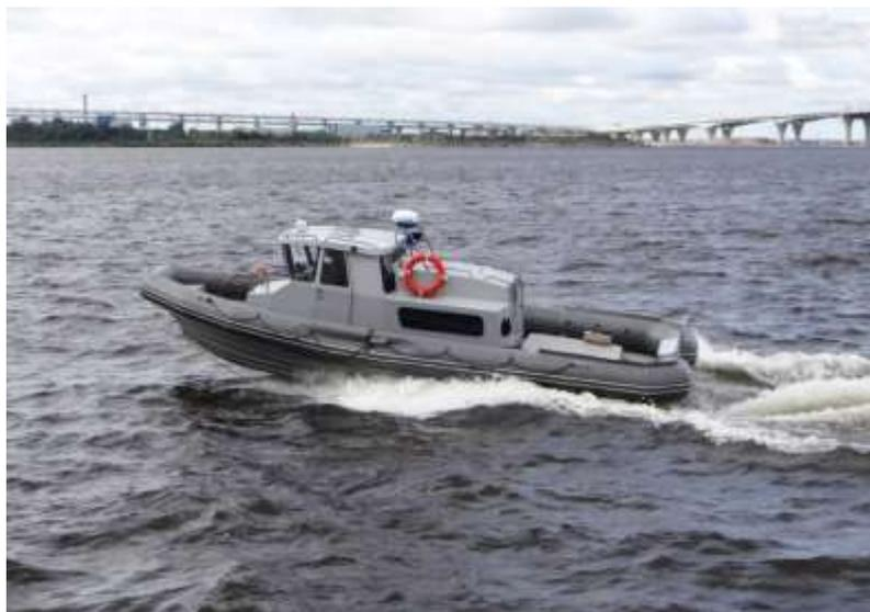
Рис. 2. Катер-бонопостановщик проекта БЛ-820
