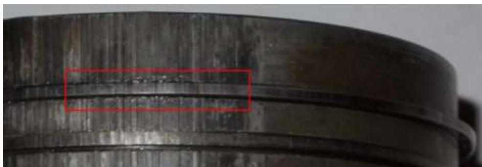
Рис. 1. Разрушение кромок верхней поршневой канавки
