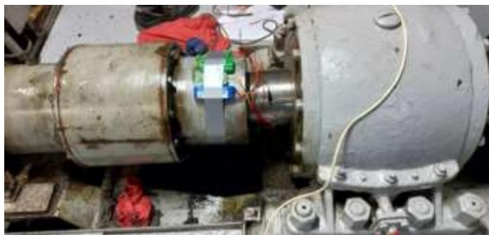
Рис. 7. Место наклейки датчиков вблизи опорного подшипника
