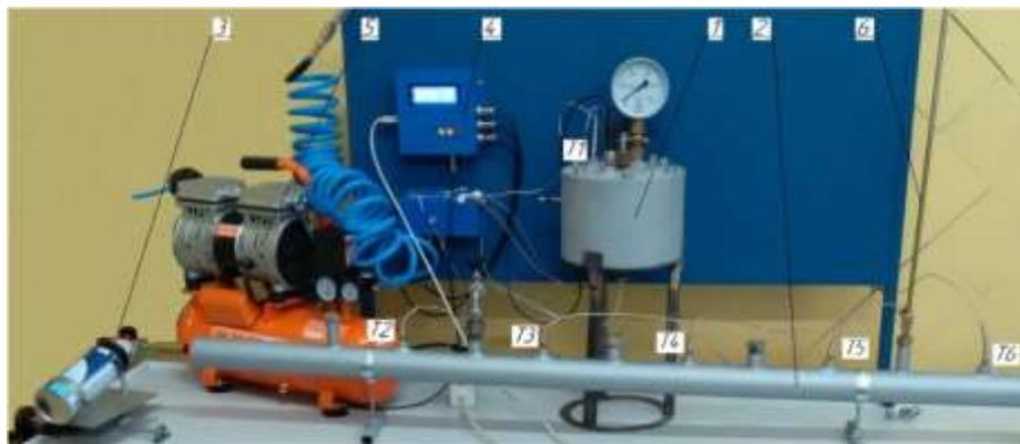
Рис. 1. Стенд для термического обезвреживания нефтесодержащих вод
