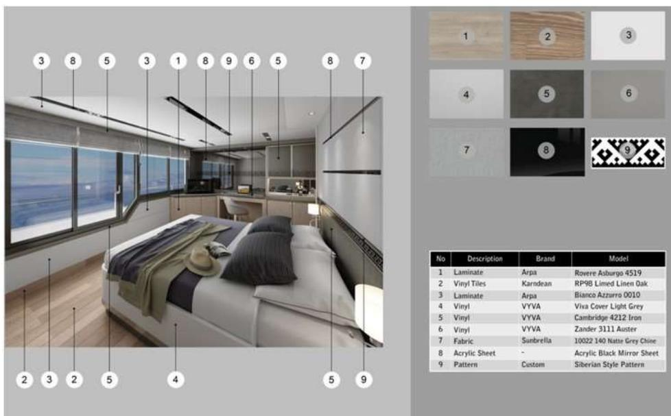
Рис. 14. Стайл-рендер гостевой каюты на яхте-катамаране пр.Е24. Разработан уникальный стиль для заказчика из Сибири, в т.ч. с использованием орнаментов
