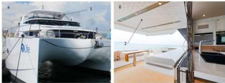
Рис. 10. Внешний вид подволока; а - на катамаране Sungeef; б - на катамаране пр.СС48. Показаны дефекты глянцевой поверхности (1) и текстурированное покрытие (2)
