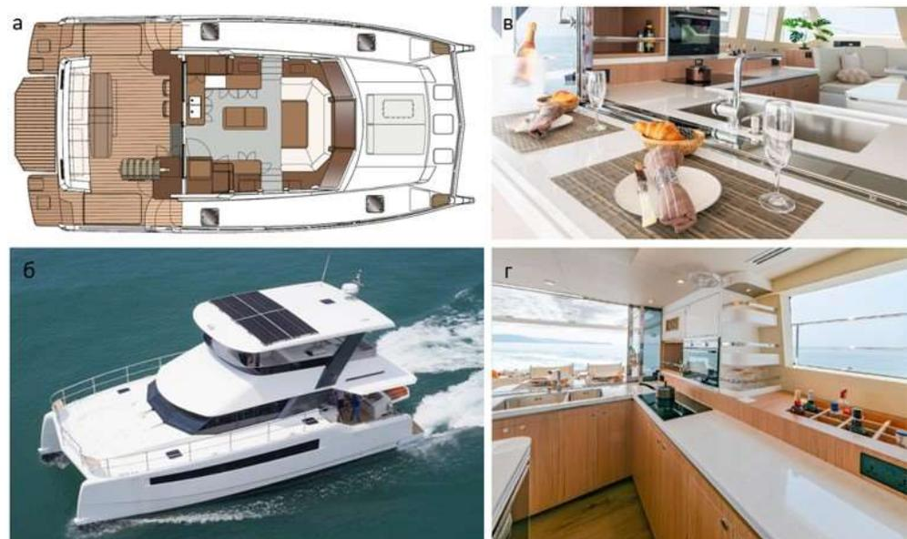
Рис. 1. Прогулочный катамаран пр.СС48; а – план главной палубы; б - общий вид судна; в, г - обитаемое пространство кормовой палубы, объединенной с салоном
