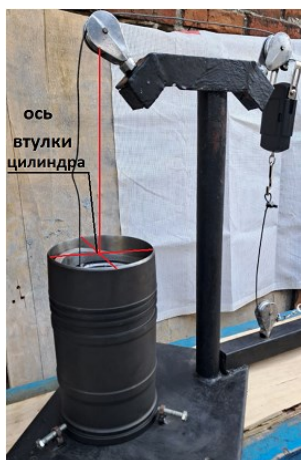
Рис. 11. Общий вид стенда для замера величины силы трения
