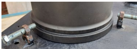
Рис. 12. Установка центрирующих и фиксирующих болтов
