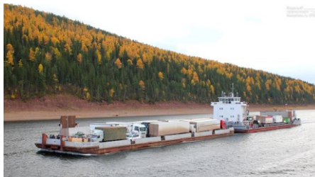
Рис.1. Судно типа СК-2000 для перевозок накатных грузов
