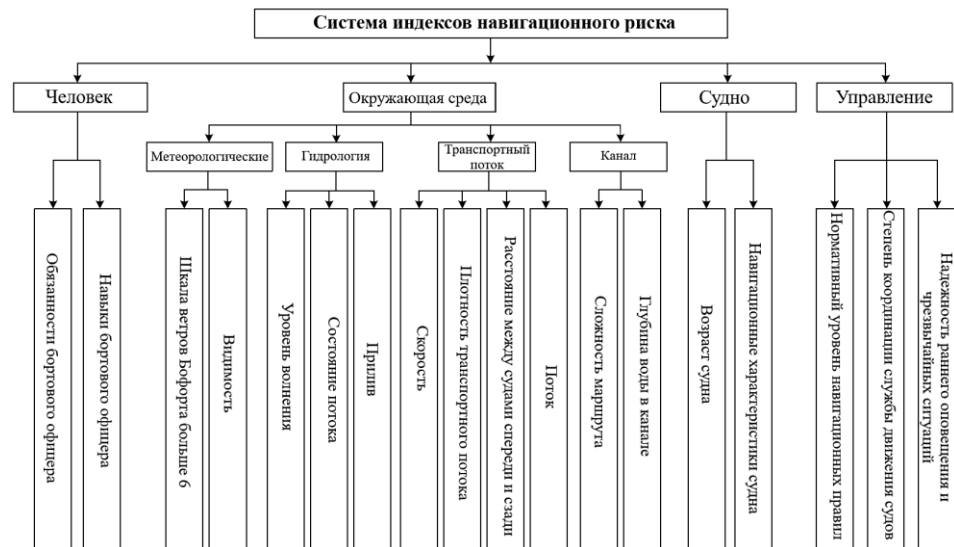
Рис. 2. Система индексов навигационного риска
