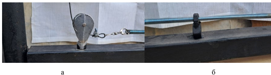
Рис. 14. Детали стэнда: а – детали соединения троса с натяжным винтом; б – упор, относительно которого перемещается натяжной винт
