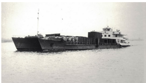
Рис. 2. Речные катамараны проектов 829 (КТ-619) и Р-19
