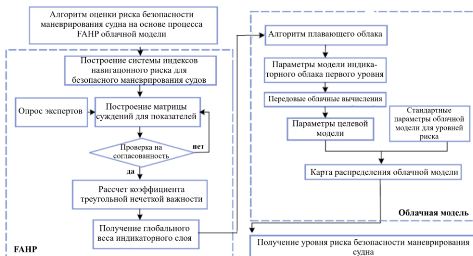
Рис. 1. Алгоритм оценки риска безопасности маневрирования судна (разработано автором)
