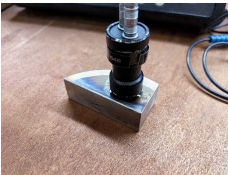
Рис. 3. Контроль скорости упругой волны
