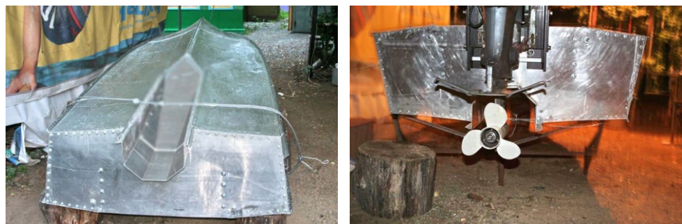
Рис. 1. Варианты тоннеля в кормовой части маломерного судна с гребным винтом (источник фотографий https://spyship.ru/testy/zashhita-lodochnogo-motora-i-grebnogo-vinta-tunnelem.html )
