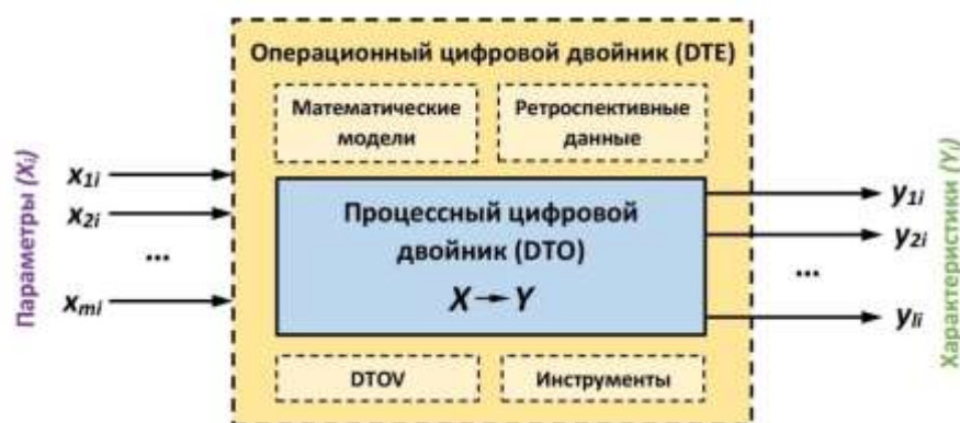
Рис. 4. Процессный эксплуатационный цифровой двойник судна
