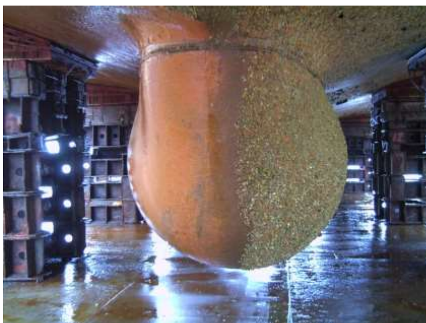
Рис. 2. Корпус судна после очистки акустическим методом
