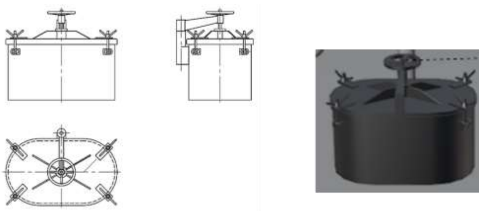
Рис. 4. Эскизы и трехмерная модель сходного люка в грузовой танк
