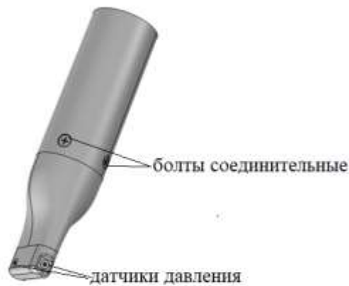
Рис. 3. Модель гидродинамического лага с расположенными датчиками давления
