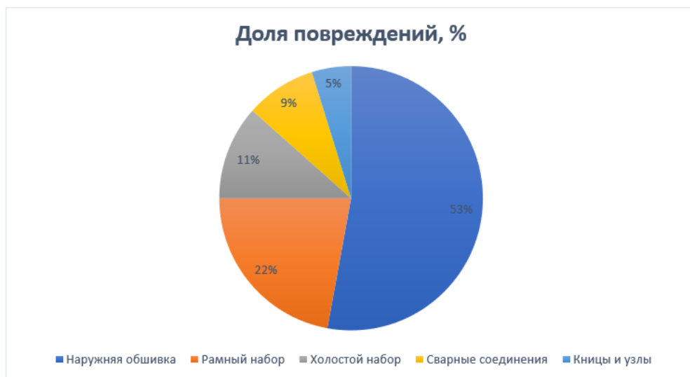
Рис. 2. Распределение критических повреждений по элементам корпусов судов
