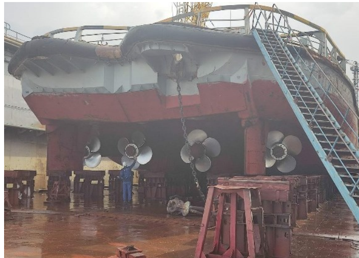
Рис. 1. Ремонт судна с четырьмя валовыми линиями
