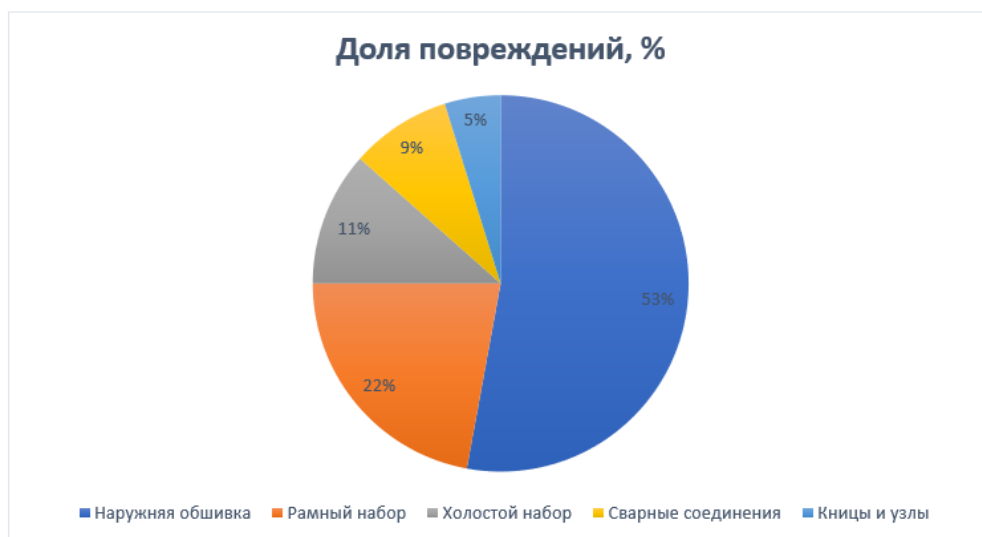
Рис. 2. Распределение критических повреждений по элементам корпусов судов
