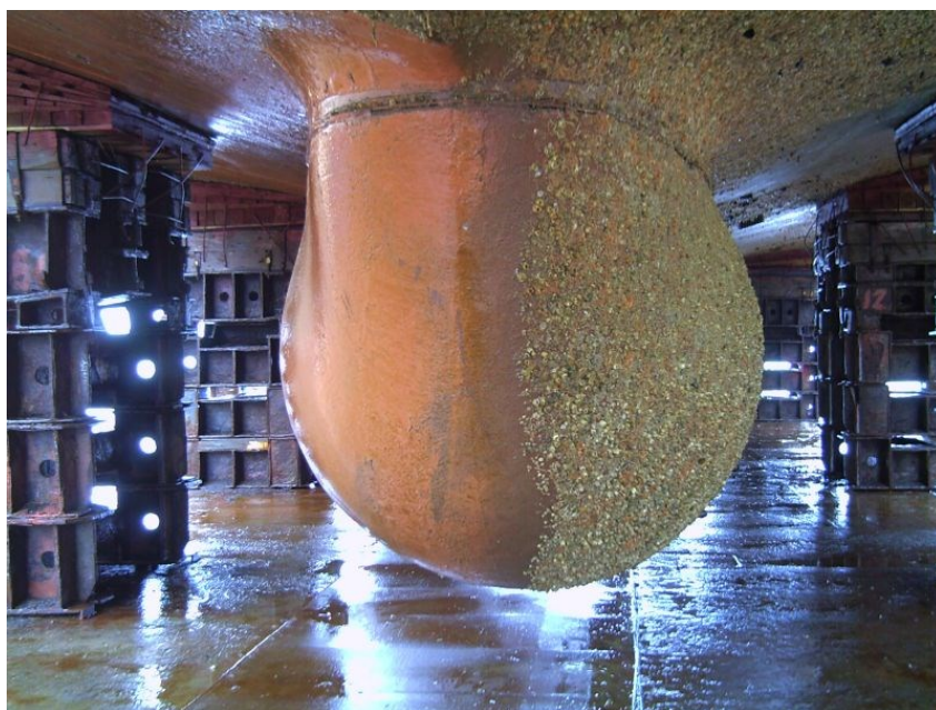
Рис. 2. Корпус судна после очистки акустическим методом
