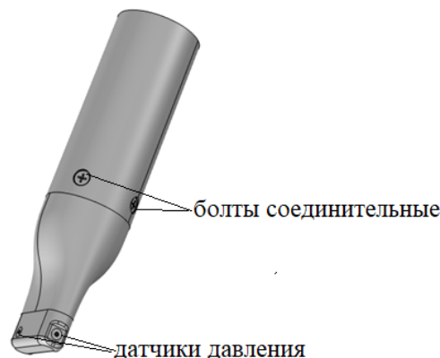
Рис. 3. Модель гидродинамического лага с расположенными датчиками давления
