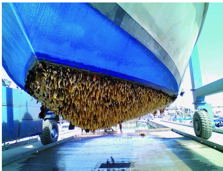
Рис. 1. Обрастание корпуса судна морскими организмами
