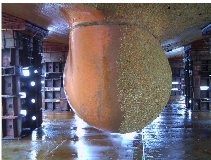
Рис. 2. Корпус судна после очистки акустическим методом
