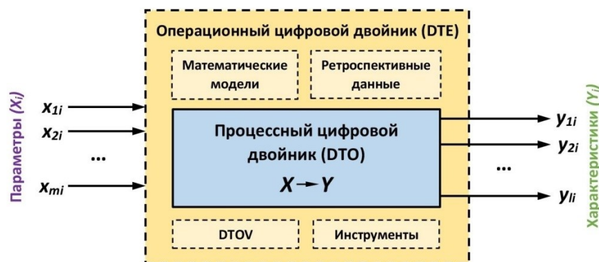
Рис. 4. Процессный эксплуатационный цифровой двойник судна
