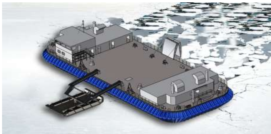
Рис. 1. Архитектурно-конструктивный тип ледокольной платформы на воздушной подушке
