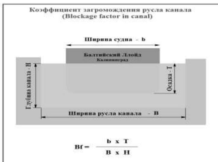
Рис. 1. Коэффициент загромождения русла канала
