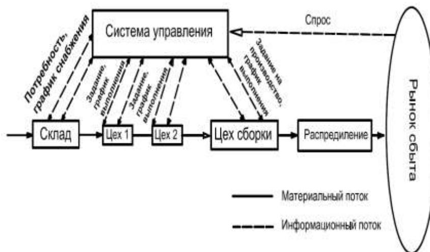
Рис. 1. Схема толкающей системы
