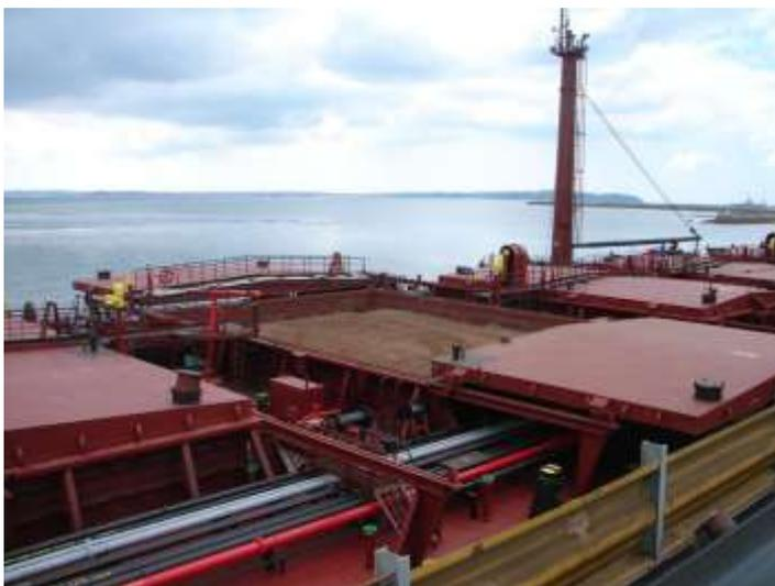
Рис. 2. Нефтенавалочники-рудовозы типа ОВО (Oil/Bulk/Ore carrier)
