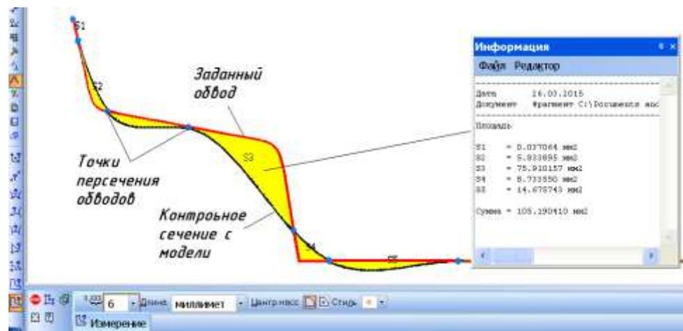
Рис. 6. Определение интегральной ошибки моделирования поверхности судна
