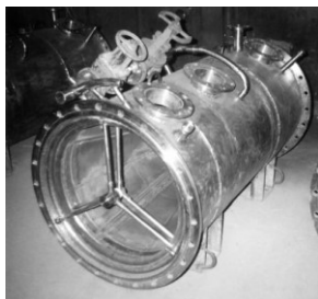
Рис. 4. Рыбозащитное устройство типа «конусная сетка» морской буровой установки «Исполин»
