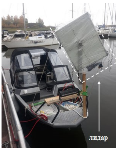
Рис. 3. Лазерный ультрафиолетовый флуоресцентный лидар УФЛ-9 на борту моторной лодки Волжанка-46
