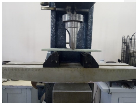
Рис. 12. Испытание образцы ПКМ в машине на изгиб
