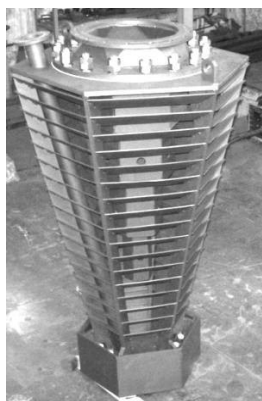
Рис. 5. Рыбозащитное устройство жалюзийного типа с потокообразователем морской платформы ЛСП-1
