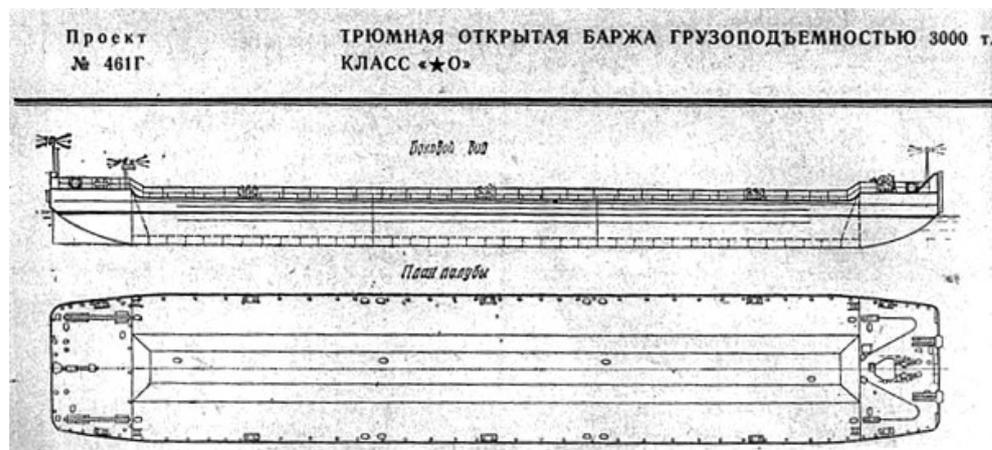
Рис. 1. Схема общего вида баржи пр.461Г
