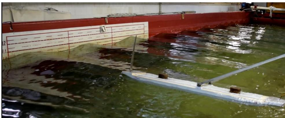
Рис. 4. Проверка устойчивости модели в положении «лагом к волне»
