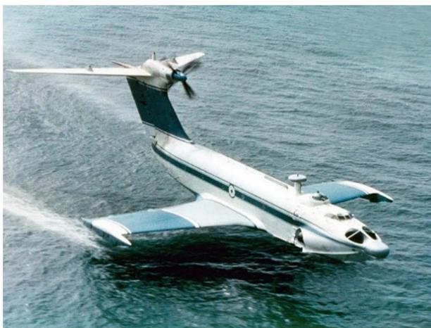
Рис. 2. Полет экраноплана «Орленок» у «экрана»
