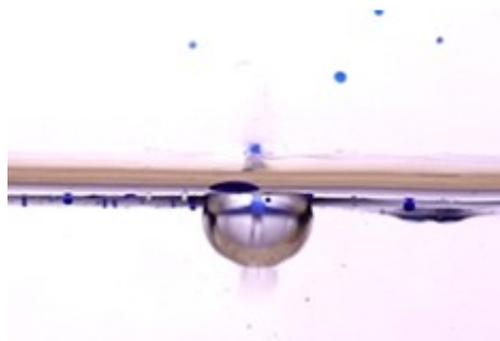
Рис. 3. Момент формирования воздушной каверны под пленкой при ее интенсивном облучении (фронтальный разрез).
