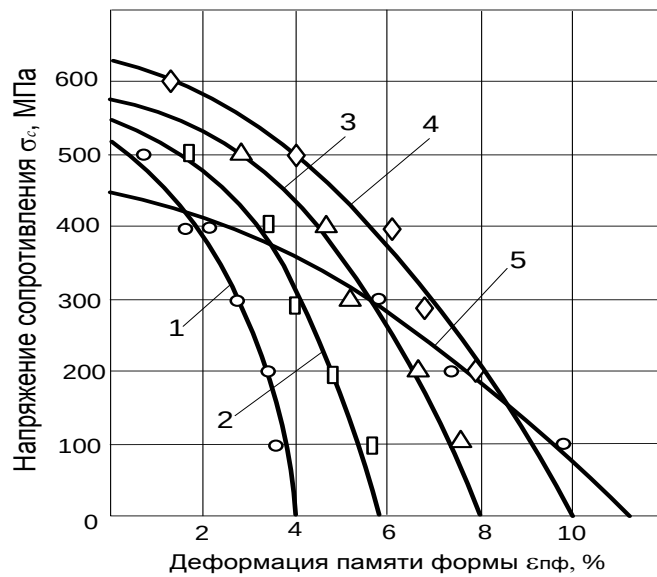
Рис. 1. Деформационно-силовые зависимости: 1–5 напряжения наведения от 100 до 500 МПа
