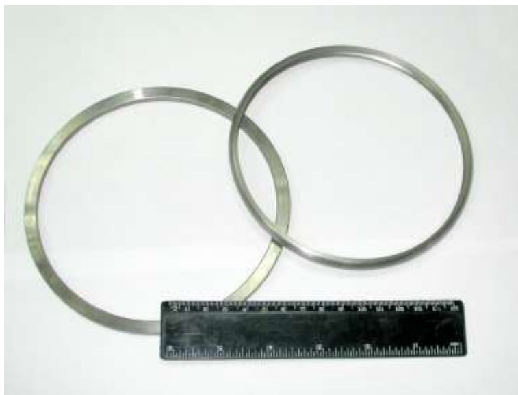
Рис. 4. Общий вид кольцевого элемента 1 из сплава с памятью формы и пружины 3
