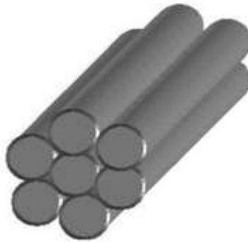
Рис. 5. Схематичное изображение углеродных нанотрубок, объединенных в пучок [1]
